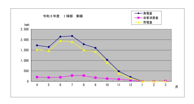
令和3年度 J 様 邸 発電実績 (システム容量 5.5 kw) (kwh)
