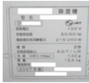
▲銘板記載例（除湿器）
